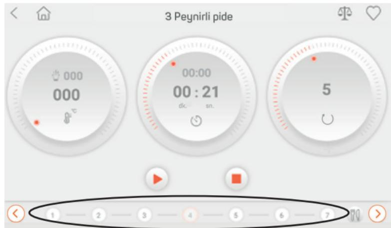
14-Nach Abschluss des Vorgangs wird das Ende auf dem Display angezeigt. Der Vorgang wird unterbrochen, wenn Sie die Einstelltaste drücken. Wenn Sie den Vorgang unterbrechen möchten, drücken Sie die Einstelltaste. Drücken Sie dann erneut, und Ihr Roboter wird den Vorgang fortsetzen. Wenn Sie die Einstelltaste lange drücken, beendet Ihr Roboter den Vorgang.
